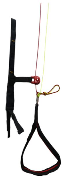
Étape 9. Fermez le noeud avec la suspenste principale et l' auxiliaire.
