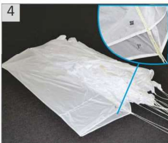
4-Commencer le pliage par le premier panneau, comme indiqué sur la photo
